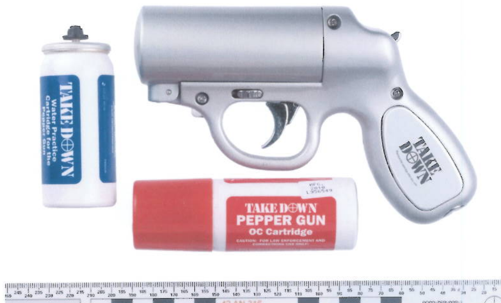
Abb. 4: Mace Pepper Gun, Ansicht links mit zwei Kartuschen
